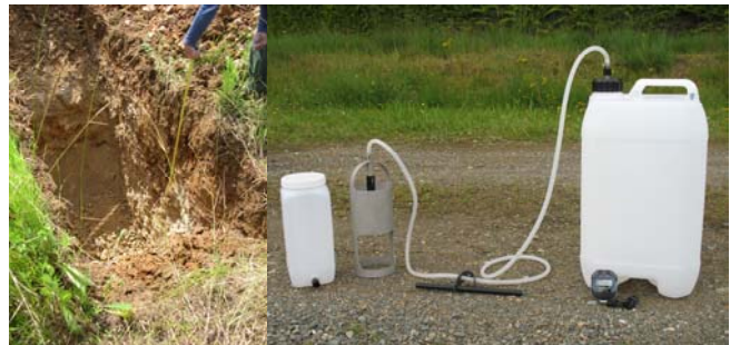
Exemple de test de perméabilité (PORCHET)
