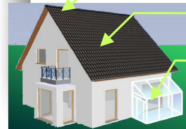
Une **couverture** en grands éléments (plaques de fibrociment par exemple) peut nécessiter un renforcement ou son remplacement par une couverture en petits éléments (ardoises ou tuiles).
