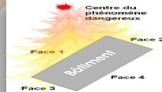
Façades : L'orientation du bâtiment vis à vis du centre du phénomène dangereux permet d'en numérotter les faces. Selon le type et la durée de l'onde de surpression, la composition des parois opaques lourdes, il peut être nécessaire de traiter jusqu'à 3 faces (faces 1, 2 et 3 dans l'exemple ci-contre)
