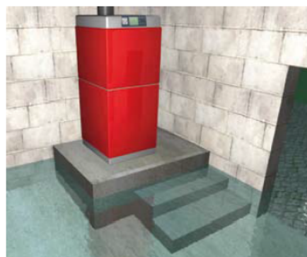
Protection d'un équipement de chauffage par surélévation.
